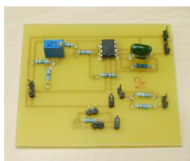
圖 6. 訊號放大電路/積分線路(a)示意圖及(b)實體照片。
